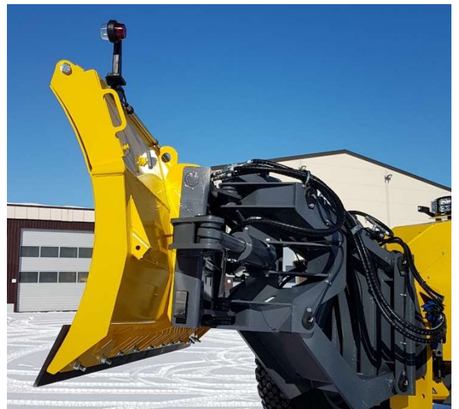
Nouseva/laskeva, kääntyvä ja kallistuva monitoimipuskulevy, kulutusterien säilytyslokero ja tukijalan paikka
