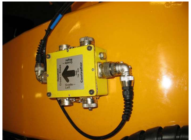
Display/kontrollenhet (överst), en av sensorer för tvärfallsautomatik (nederst till vänster) och en ventilblock för RGväghyvel (behövs inte för FG-väghyvlar)
