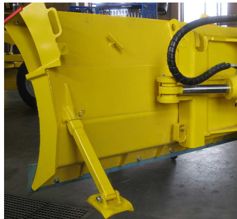
Nouseva/laskeva, kääntyvä ja kallistuva monitoimipuskulevy, kulutusterien säilytyslokero ja tukijalka
