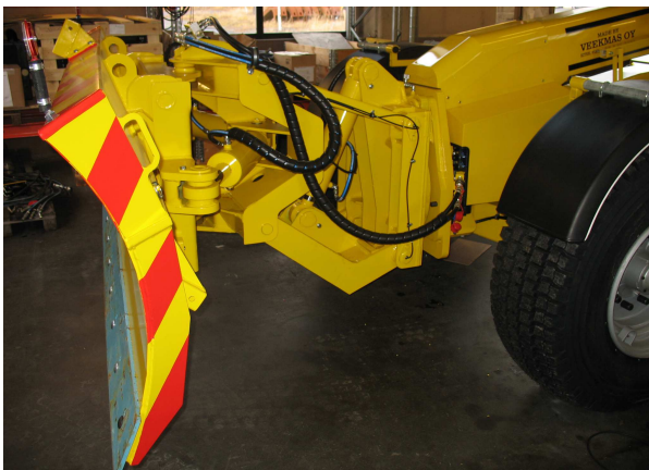
Nouseva/laskeva, kääntyvä ja kallistuva monitoimipuskulevy, kulutusterien säilytyslokero ja tukijalka
