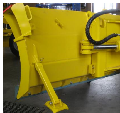
Nouseva/laskeva, kääntyvä ja kallistuva monitoimipuskulevy, kulutusterien säilytyslokero ja tukijalka
