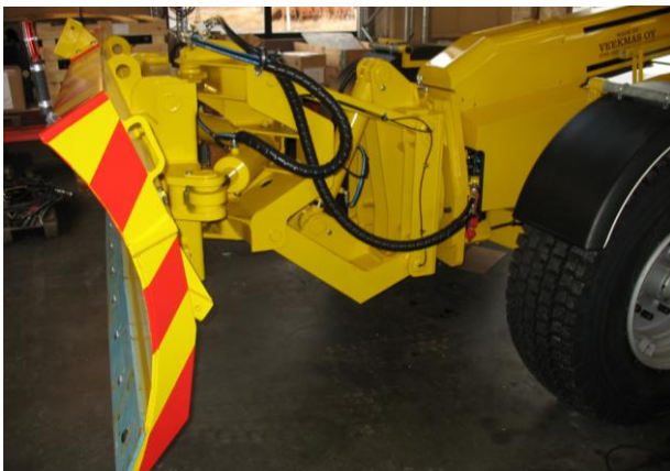
Nouseva/laskeva, kääntyvä ja kallistuva monitoimipuskulevy, kulutusterien säilytyslokero ja tukijalka
